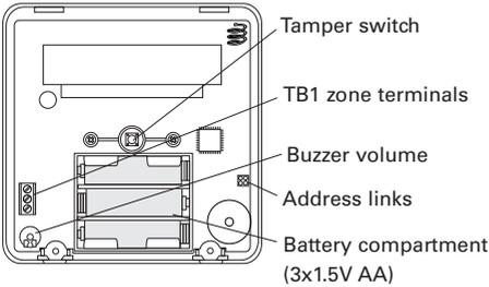
Figure 6. Keypad PCB
